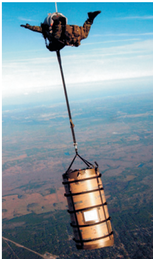
Буксировщик может сбрасываться с воздушного судна совместно с парашютистом на управляемой планирующей парашютной системе в специальном пластиковом цилиндрическом контейнере типа TORDS
