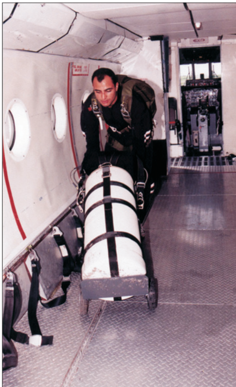
Буксировщик может сбрасываться с воздушного судна совместно с парашютистом на управляемой планирующей парашютной системе в специальном пластиковом цилиндрическом контейнере типа TORDS
