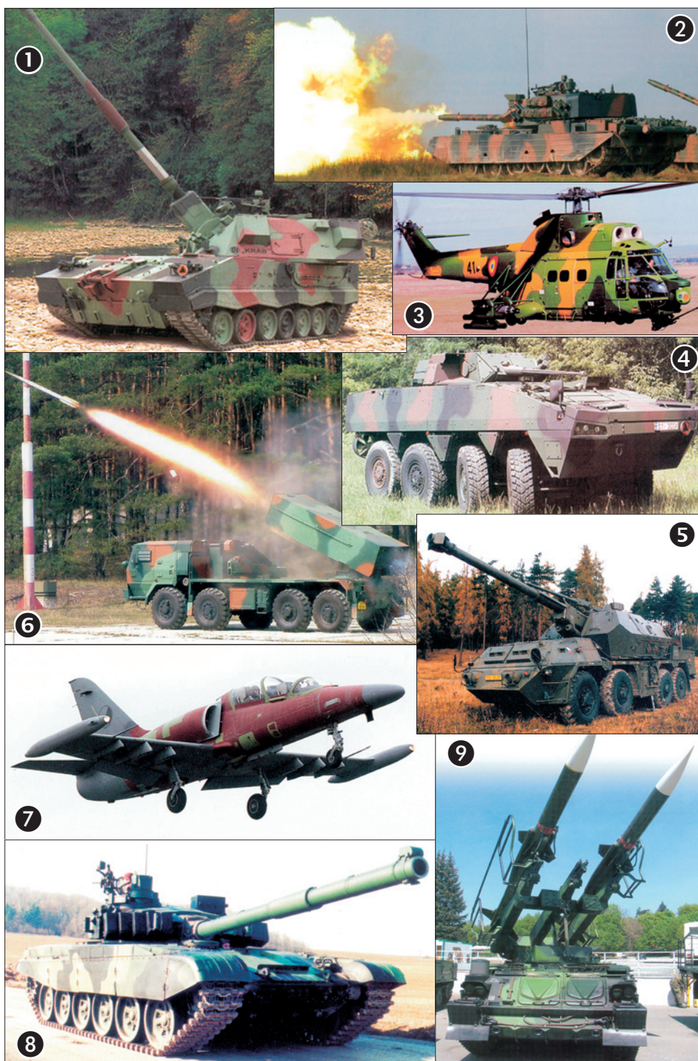
Новые страны НАТО (из числа ранее входивших в ОВД) ведут разработки и принимают на вооружение современные образцы ВВТ: 1. 155-мм самоходная гаубица «Краб» (Польша). 2. Румынский ОБТ BIZONUL. 3. Румынский боевой вертолет IAR 330 Socat. 4. БТР XR360 «Росомаха» (Польша). 5. Чешская самоходная гаубица «Дана». 6. Словацкая модернизированная РСЗО RM-70/85 MODULAR. 7. Чешский учебно-боевой самолет L-159. 8. Словацкий ОБТ. 9. Чешский самоходный ЗПК.
